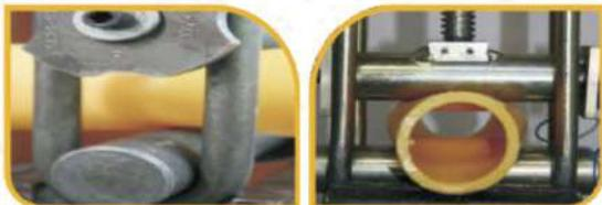
Se coloca la herramienta sobre el centro del tubo y perpendicular a éste. Esto permitirá que el tubo se aplaste libremente, sin que se atasque contra el armazón de la herramienta o los rebordes. La colocación de la herramienta debe ser mínimo a cinco diámetros del tubo o 30 cm mínimo entre el punto de la termofusión del tubo con tubo; tubo con accesorio u otro punto de aplastamiento.
